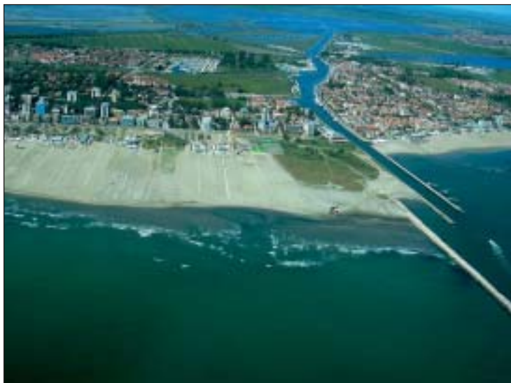
Grande sviluppo delle spiagge sopraflutto di Lido degli Estensi ed arretramento di quelle di Porto Garibaldi (sottoflutto)
