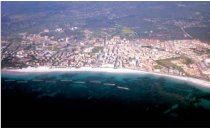
Lido di Alghero. Sono visibili le nove barriere parallele a difesa degli stabilimenti balneari.
