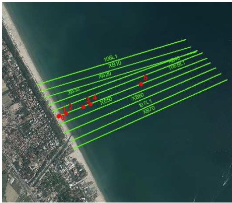
Figura 1 Sezioni rilevate (linee verdi) e punti di campionamento dei sedimenti (punti rossi).
