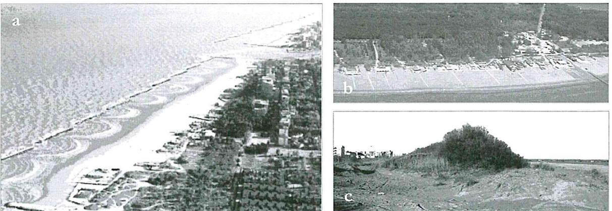
Figura 7 - Frammentazione e smantellamento dei cordoni dunari operati per l'inserimento di strutture turistico-balneari lungo le spiagge del Lido di Classe (a) e del Lido di Volano (b); isolato lembo del cordone dunare che bordava il litorale del Lido Adriano (c).
