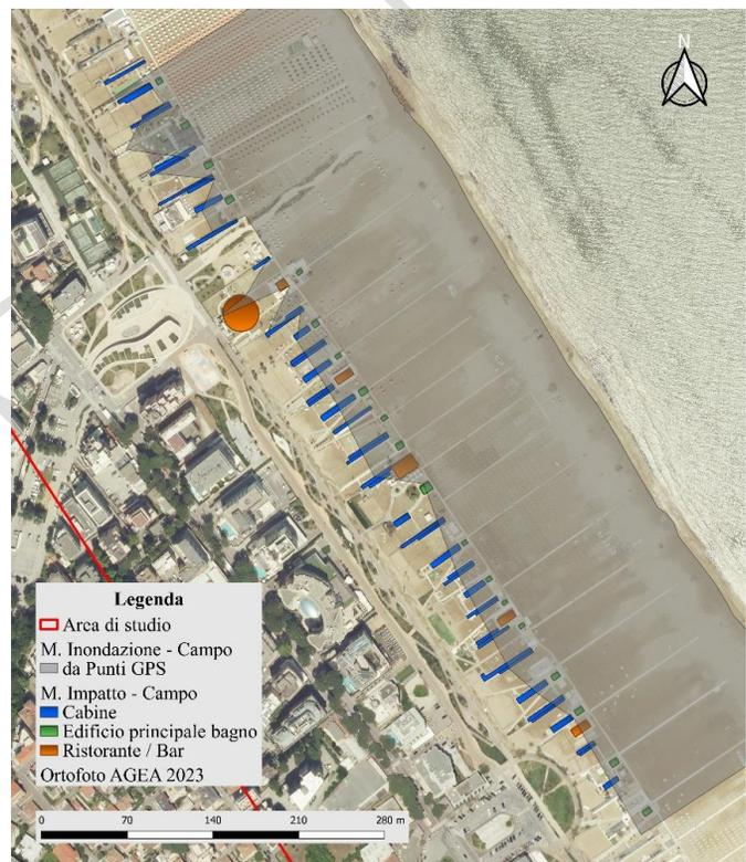
**Figura 2. Mappe di impatto e di inondazione prodotte in QGIS sulla base dei dati acquisiti sul campo.**
