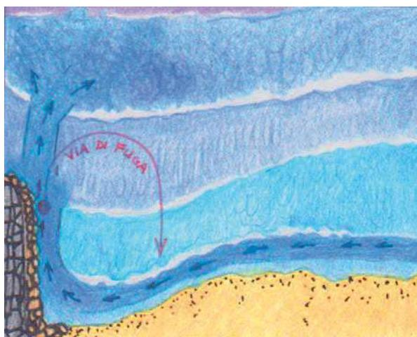
Figura 4. Effetti di un pennello su una corrente di deriva litoranea.
