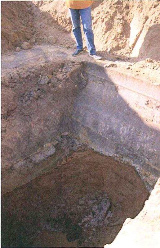
Figura 4 – Sabbie litorali sottostanti il livello di calcare palustre (centro della foto); il passaggio sottostante è marcato da un orizzonte di argille sabbiose (Ponte Fixi).
