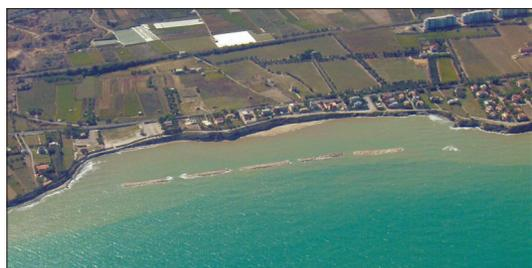
**Figura 5a - Fotografia scattata immediatamente dopo la realizzazione delle barriere emerse (2003).**
