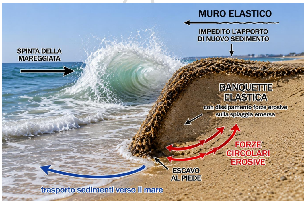
Figura 2. Schema concettuale delle interazioni onda-banquette-sedimenti: escavo al piede della banquette, possibile crollo franoso e aumento locale della profondità del fondale antistante.
