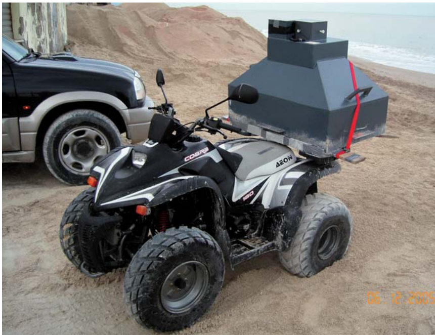
Figura 4 - Camera UV portatile montata sul veicolo utilizzato.
