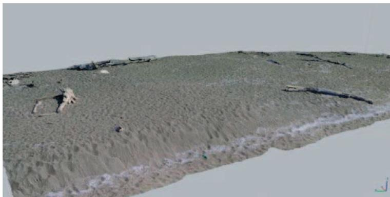
Figura 3. Nuvola dei punti 3D da rilievo drone con legname spiaggiato.
