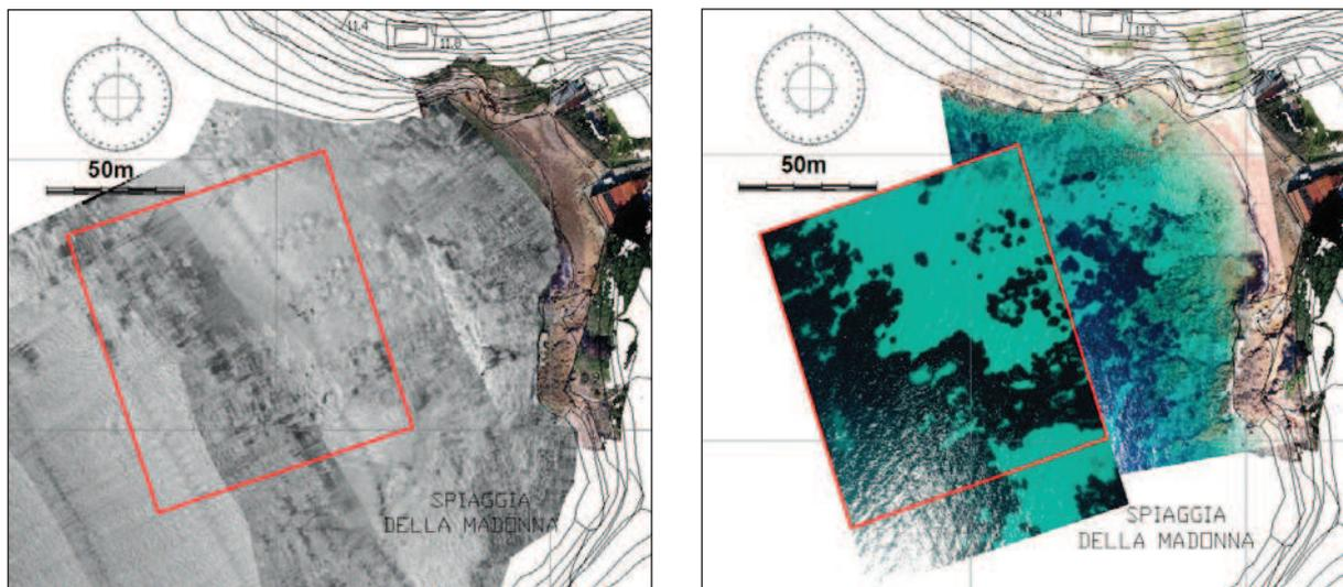
**Figura 10. Immagine SSS (sx) e ortofoto da drone (dx) con limiti area A in rosso.**
