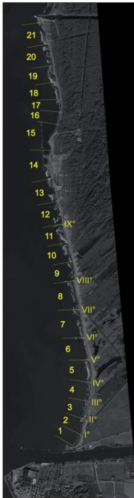
Figura 5 - Settori nei quali è stato diviso il litorale per l'analisi dell'evoluzione della linea di riva. I numeri romani identificano i pennelli. Base immagine Quickbird del 01/07/2005.
