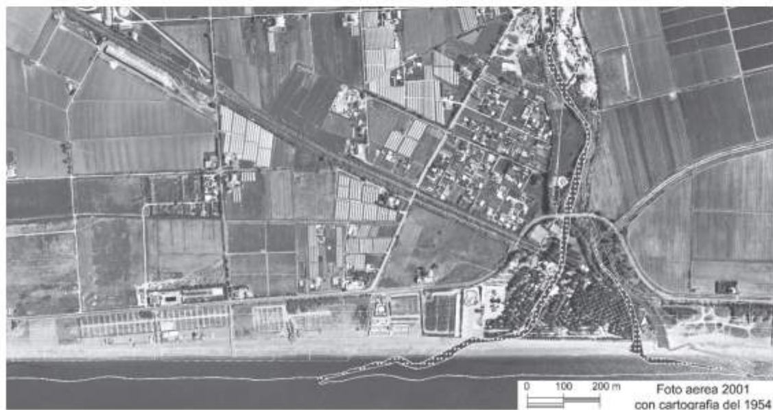
Figura 3 - Variazione della linea di riva, e ambienti di transizione collegati, alla foce del Fiume Tusciano risultante dall'analisi diacronica basata su aerofoto del 2001 e sulla cartografia I.G.M.I. del 1954.
