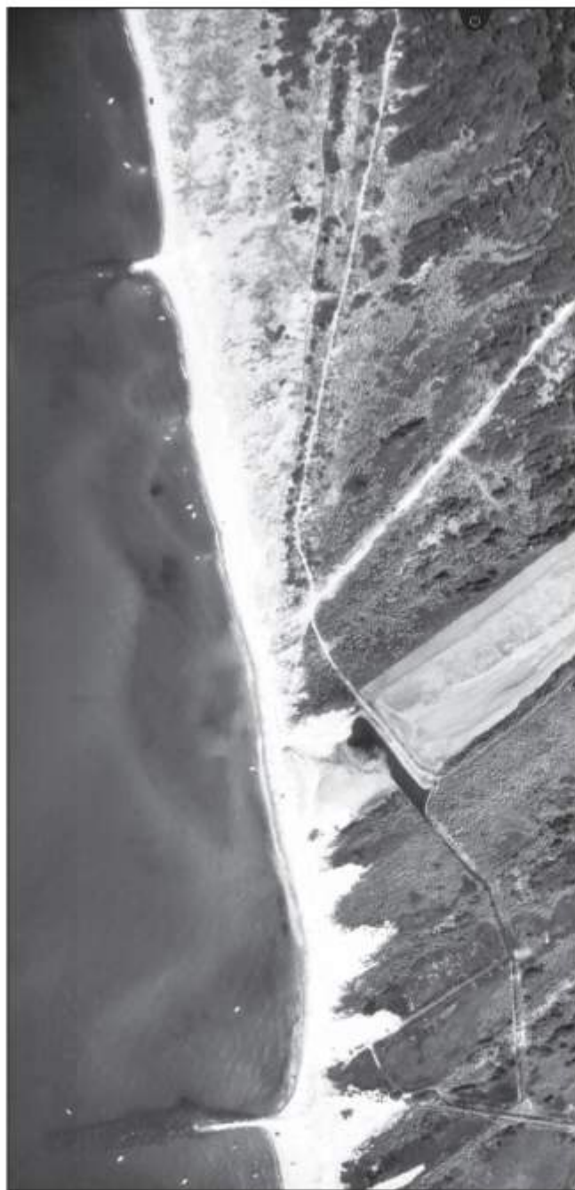
Figura 4 - Il tratto settentrionale dell'intervento in cui si vedono i pennelli VIII e IX prolungati in setti sommersi che raggiungono la zona in cui si muovono le barre. I lobi chiari visibili nella parte meridionale dell'immagine sono washover fans che si formano preferenzialmente in corrispondenza dei bassi interdulari.
