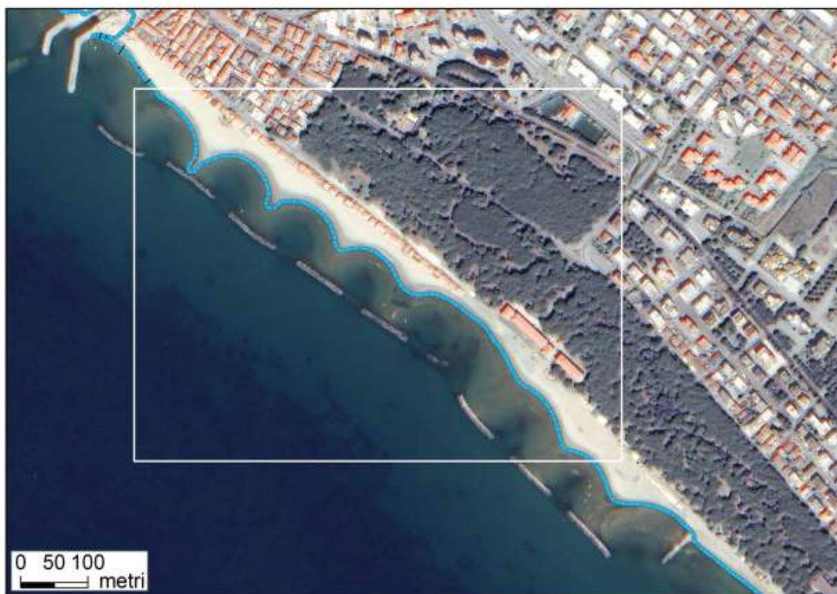
Figura 1 - Immagine Ikonos della spiaggia di Follonica acquisita il 18/04/2007 (Bande 1-2-3; B-G-R) sulla quale sono state effettuate tutte le elaborazioni. Nel riquadro il tratto di costa per il quale vengono presentati i dati nelle figure successive (in blu la linea d'acqua rilevata con GPS).
