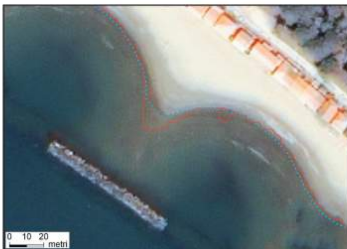
Figura 10 - Linea di riva estratta dal rapporto B2/B4 (in rosso) linea d'acqua da DGPS (punti ciano). Si noti come la distanza fra le due linee sia
