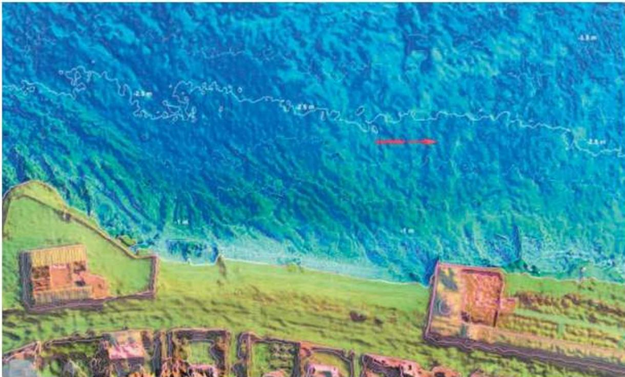
Figura 2. DEM topo-batimetrico con curve di livello ottenuto da rilievo con drone.
